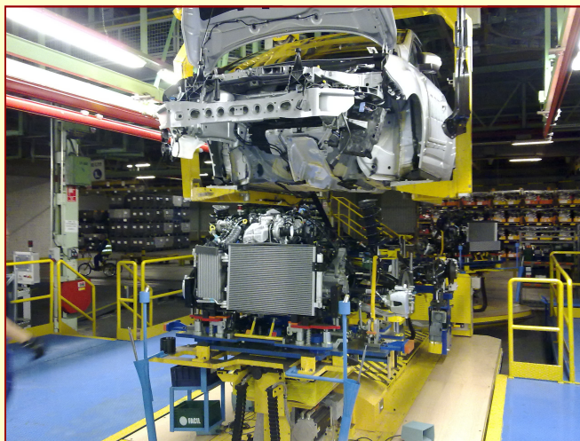
Planta de Montaje Final - Nuevo "Decking" (Rail Guided Vehicle)
