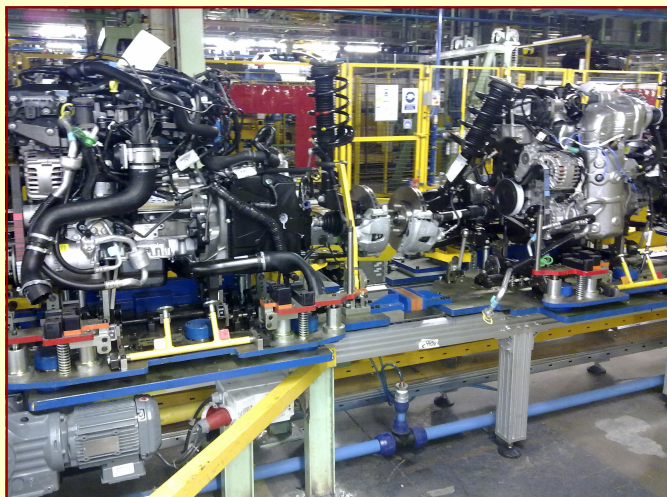
Planta de Montaje Final - Nuevo "Decking" (Rail Guided Vehicle)
